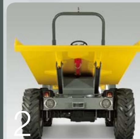
2 La garde au sol importante, combinée à la transmission hydrostatique à quatre roues motrices et au châssis articulé oscillant, assure de remarquables performances en tout-terrain.
